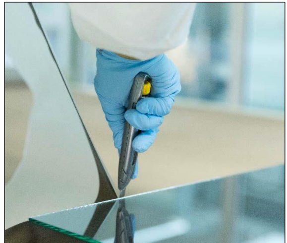
Manueller Zuschnitt der Verbundfolie
